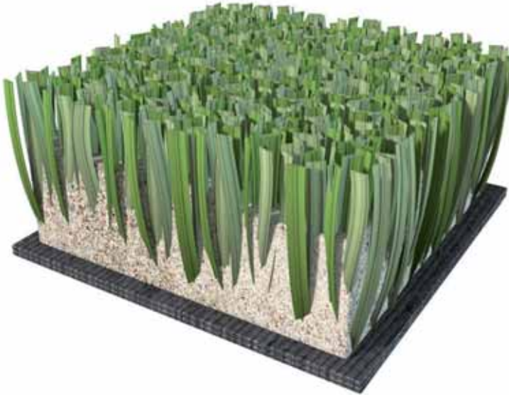
Figura 1. Estructura del césped artificial de segunda generación
