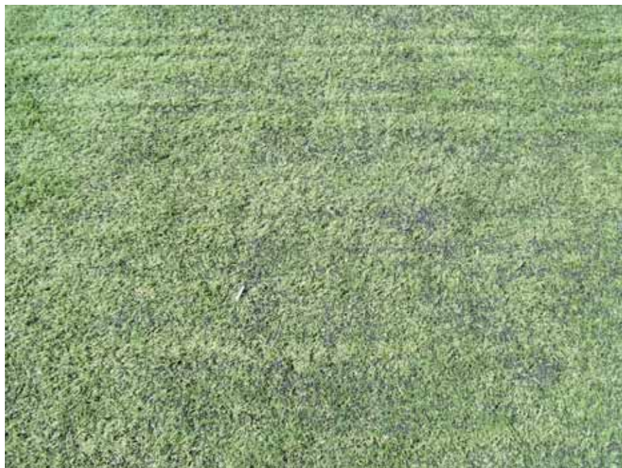
Figura 20. Césped artificial con fibra inclinada y por tanto expuesta al desgaste
